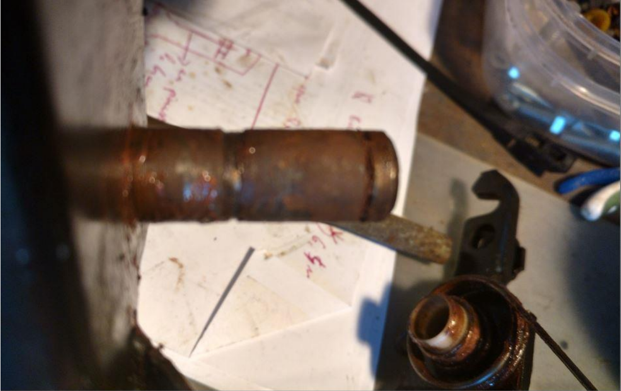
La cause du grippage vient de la rouille mais aussi de la graisse de montage qui a durcie
