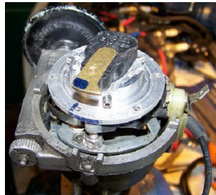
Mise en allumage électronique MULTIC de tout allumeurs à Vis Platinées.
