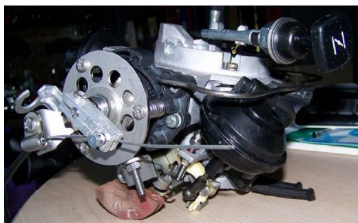
starter manuel INOX sur PIERBURG 2E2 VW
