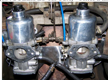
SU HIF 38 rempli HS4 sur Spit 1500 ZENITH 150CD sur GT6 HIF 44 pour toute JAGUAR TR3 à 6 VOLVO/ rempl. aussi ZENITH 175 CD anglais (pas « allemands »)
