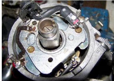
Mise en allumage électronique MULTIC de tout allumeurs à Vis Platinées.
