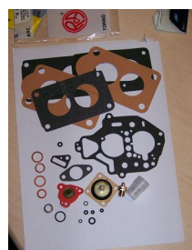
pochette carbu. SU HIF 44 (ex : SOLEX Z1 sur PSA) boîtes à air chrome
