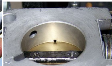
Réglage de base de la BUTEE de Ralenti à chaud (« T » avec barre verticale d' 1 mm)
