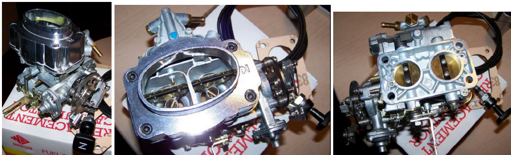
WEBER 32 36 DGV remplace SOLEX 32 DIDTA sur OPEL GT 1.9 (& 32 TDID sur MATRA 530 1.7)
