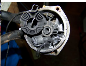
Souvent le bilame tombe et la résistance chauffante est HS
