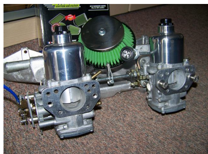
pochette carbu. SU HIF 44 (ex : SOLEX Z1 sur PSA) boîtes à air chrome
