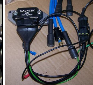
Mise en allumage électronique MULTIC de tout allumeurs à Vis Platinées.
