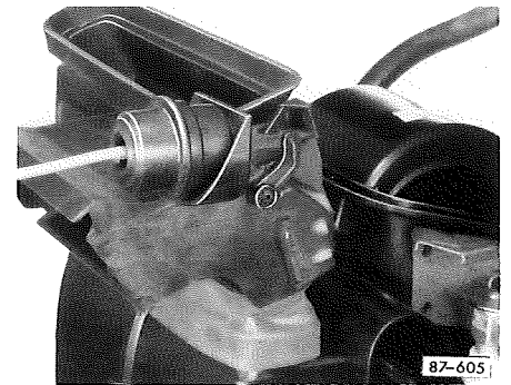
Capsules de dépression du boîtier de répartiteur d'air
