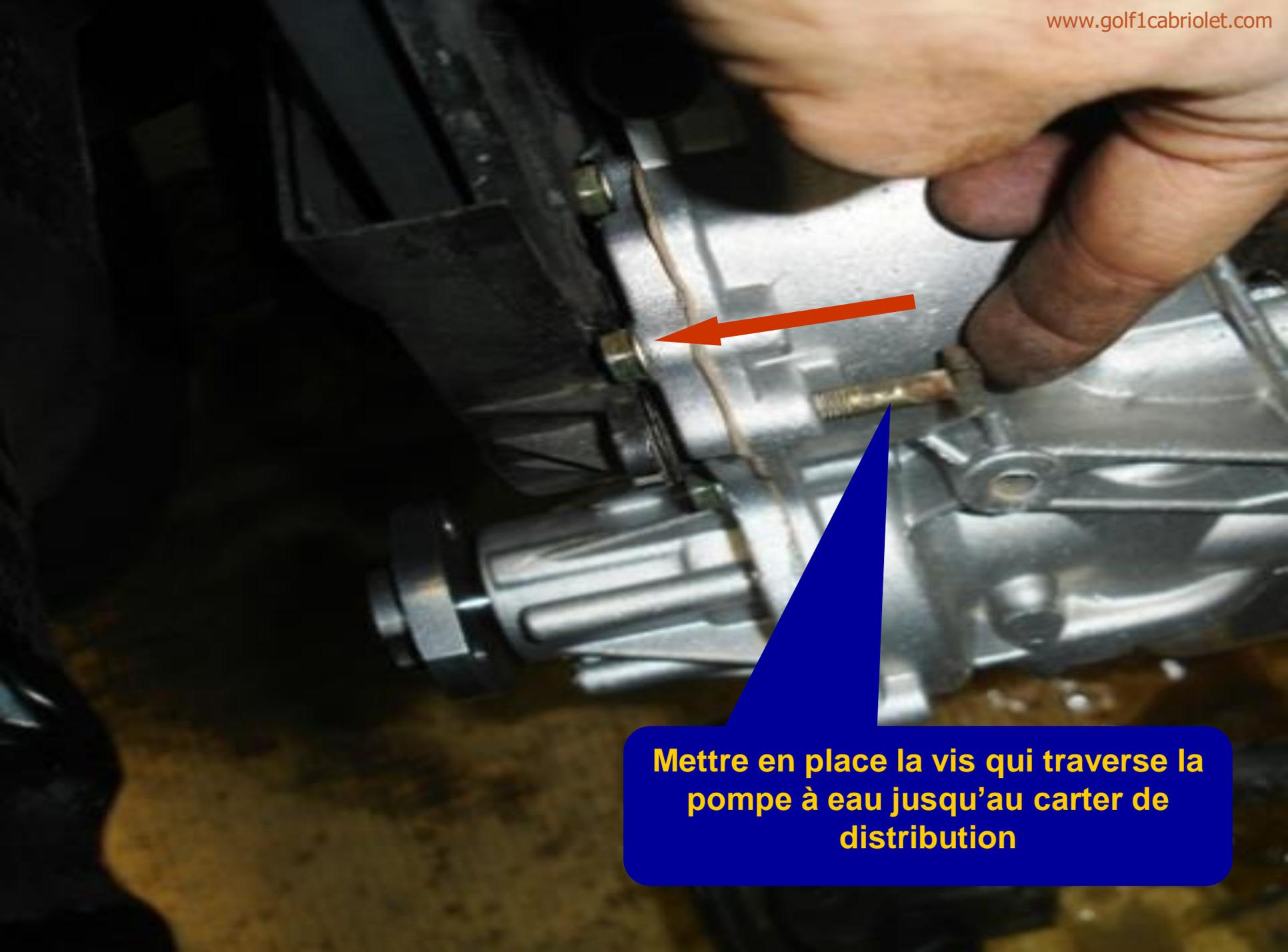
**Mettre en place la vis qui traverse la pompe à eau jusqu'au carter de distribution**
